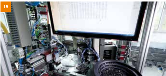
Dit wordt gevolgd door een controle van de geometrie van de bougie: De definitieve afmetingen en de exacte concentriciteit worden vastgelegd door een camerasysteem.
