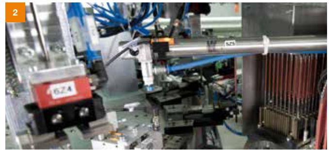
2 Start van het volledig geautomatiseerde productieproces: Het aanbrengen van het verwarmingselement en het verlengstuk...
