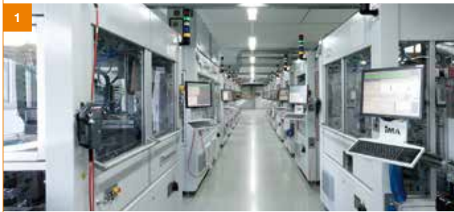
1 Een kijkje in de modulaire productielijn voor PSG-gloeibougies met druksensor.
