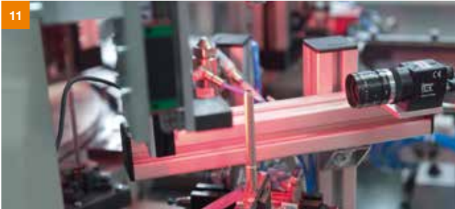
De aanvoer van het bovenste gedeelte van de gloeibougje wordt bewaakt en vastgelegd door een camera.
