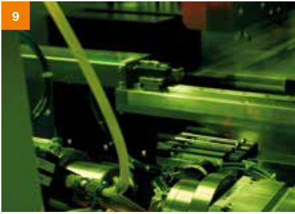
In de 6e module wordt de sensor op het verlengstuk lasergelast.
