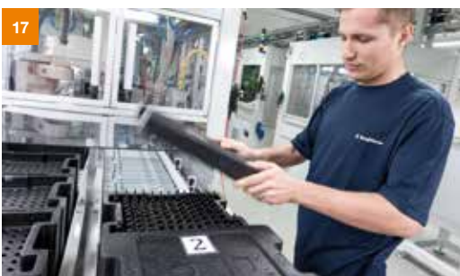
Hier worden de geteste gloeibougies met druksensor verpakt voor transport.
