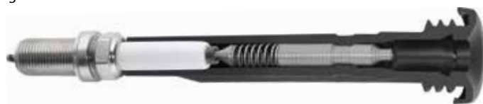
Grotere overslagweerstand ondanks een hogere ontsteekspanning: dankzij de langere bovenzijde van de isolator, de grotere overlapping, de in een uitsparing liggende drukveer en de nieuwe contacttechnologie.
