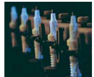
Testen van isolators op 40.000 volt: BERU-bougies moeten eerst op testbanken aantonen dat ze betrouwbaar zijn, voordat ze worden geaccepteerd voor serieproductie.
