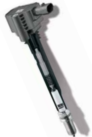
Ruimtebesparend en uiterst efficiënt BERU-ontstekingsstelsel: dubbel platina bougie met stekkerbobine. De interne ‘bowl’-connector met drukveer op de nieuwe dubbel platina bougie voorkomt isolator vonkoverslag.
